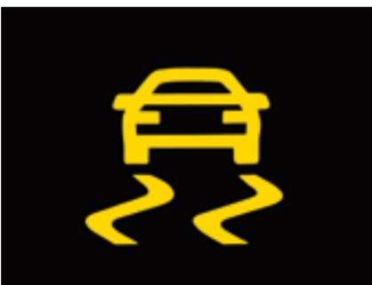
Das **elektronische Stabilisierungsprogramm** inkl. elektronischer Differenzialsperrung (EDS). Die Elektronik kann ein Ausbrechen des Fahrzeugs verhindern, indem sie kontrolliert in das Brems- und Motormanagement eingreift.<sup>2)</sup>
