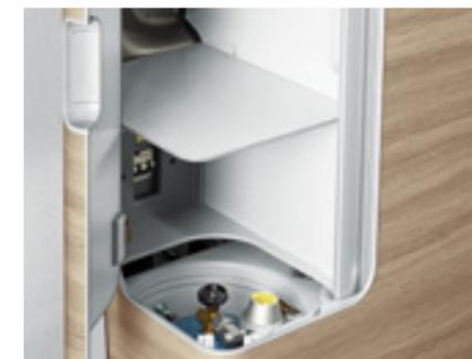
Der **hintere Schrank inklusive Gasflaschenbehälter**. Hier kann eine 2,8-kg-Camping-GAZ-Flasche für die Küchenversorgung platzsparend untergebracht werden. Die Erstbestückung mit einer GAZ-Flasche ist optional möglich.
