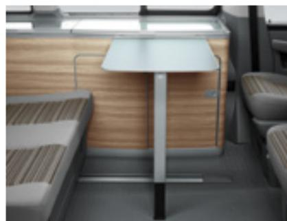
Die **flexible Arbeitsplatte**. Der verschiebbare Tisch ist an der Küchenzeile eingehängt und kann mittels eines ausklappbaren Standbeins aufgestellt werden.
