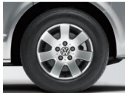
**Die rollwiderstandsoptimierten Reifen.** Der California mit BlueMotion Technology nimmt den Kontakt zur Straße über rollwiderstandsoptimierte Reifen auf. Der geringere Rollwiderstand reduziert den Kraftstoffverbrauch und damit den CO<sub>2</sub>-Ausstoß.
