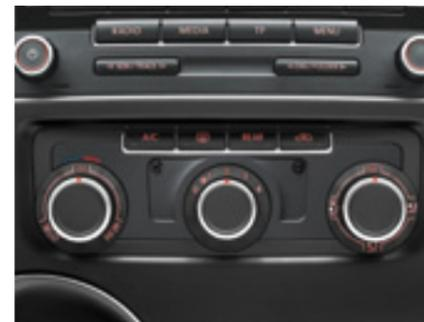
Die **Klimaanlage „Climatic“**. Diese halbautomatische Klimaanlage verfügt über einen Innenraumsensor und gleicht ständig die Raumtemperatur mit dem gewünschten Wärmegrad ab. Sie kann auf die klimatischen Bedürfnisse individuell eingestellt werden.
