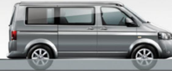
Die **Wattiefe: bis zu 300 mm**. Nach starken Unwettern durchqueren Sie mit dem California überflutete Straßen oder stehende Gewässer mit einer Tiefe von bis zu 300 mm nahezu problemlos. Gemessen bei voller Beladung und maximal 30 km/h.
