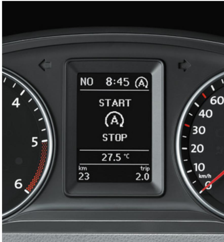
Das **Start-Stopp-System**. Es schaltet den Motor im Leerlauf und bei gelöster Kupplung automatisch ab, z. B. an einer roten Ampel. Zum Starten genügt ein Tritt auf die Kupplung und der Motor springt wieder an.
