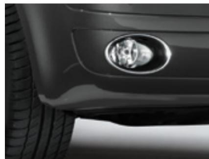
Die **Nebelscheinwerfer**<sup>1)</sup>. Sie sorgen bei schlechter Witterung für optimale Sicht und damit für hohe Sicherheit. In die Nebelscheinwerfer ist zusätzlich ein Abbiegelicht integriert.
