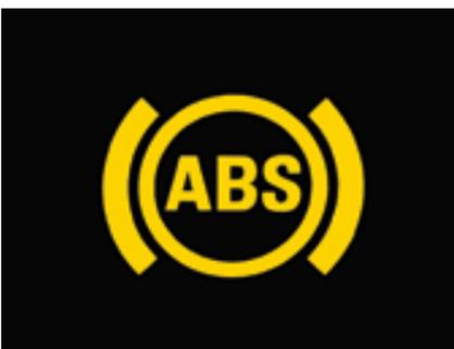
Das **Antiblockiersystem (ABS)**. Es verhindert ein vollständiges Blockieren der Räder und verbessert so die Lenkbarkeit des Fahrzeugs bei einer Vollbremsung erheblich.
