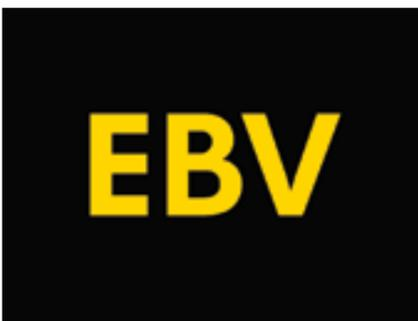
Die **elektronische Bremskraftverteilung (EBV)**. Wenn sich das Fahrzeuggewicht beim Bremsen auf die Vorderäder legt, verhindert sie das Blockieren der weniger belasteten Hinterräder.
