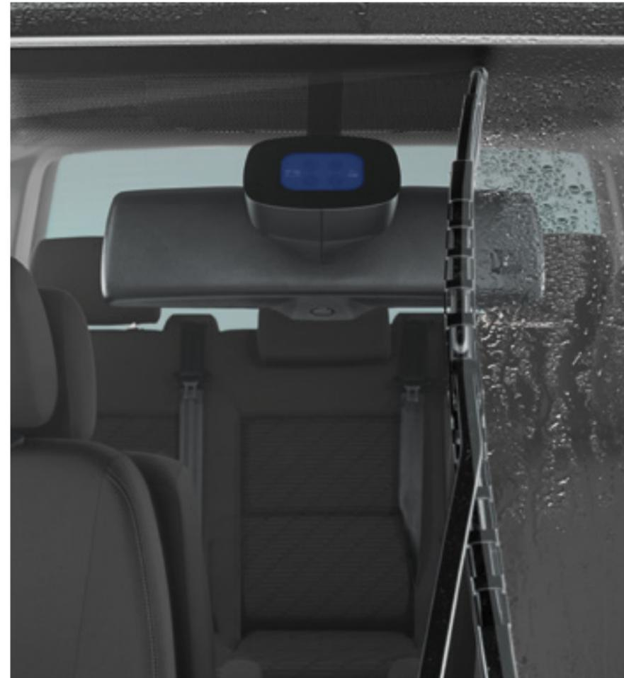
Der **automatisch abblendende Innenspiegel** und der **Regensensor**. Der Innenspiegel blendet bei zu hellen Scheinwerfern des Fahrzeugs hinter Ihnen selbsttätig ab. Das bringt Ihnen eine bessere Sicht nach vorn. Zusätzlich befindet sich im Spiegel ein Regensensor, der bereits leichten Regen auf der Windschutzscheibe registriert und sofort die Scheibenwischer aktiviert.
