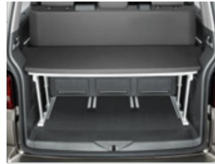
Das **Multiflexboard**. Für den California Beach ist in Verbindung mit einer 3er-Sitzbank ein Multiflexboard erhältlich. Bei umgeklappter Sitzbank ergibt sich so eine 1,50 m x 1,88 m große Liegefläche.
