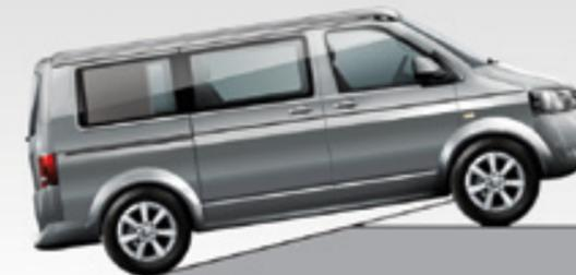
Der **Rampenwinkel: 14°**. Je mehr Spielraum zum Boden, desto mehr Spielraum bei der Campingplatzsuche. Selbst Kuppen mit einem Rampenwinkel von bis zu 14° überwindet der California nahezu spielend. Gemessen mit Serienausstattung und bei voller Beladung.
