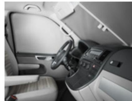
Die **Verdunkelung im Fahrerraum**. Im California Comfortline lässt sich die Frontscheibe mit zwei Rollos verdunkeln; im Beach mit einem gespannten Stoff. Die Seitenscheiben beider Modelle werden mit Stoffblenden abgedeckt.
