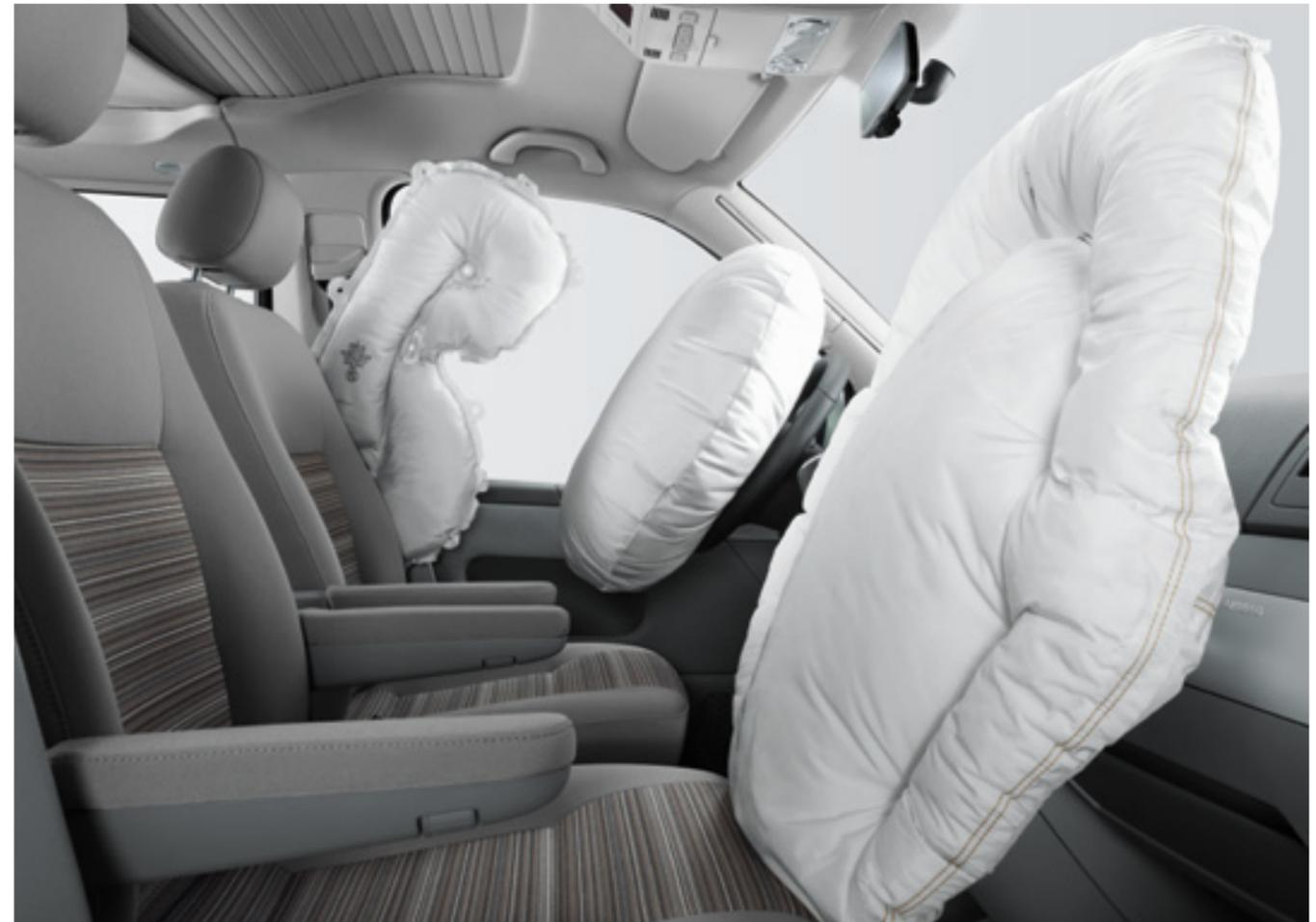
**Die Airbags.** Wer auf lange Reisen geht, will immer optimal geschützt sein. Deshalb ist der California serienmäßig nicht nur mit einem Fahrer- und einem Beifahrerairbag ausgestattet, sondern auch mit Seiten- und Kopfairbags. Der Beifahrerairbag kann mit dem Fahrzeugschlüssel deaktiviert werden.
